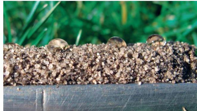
WDPT-Test (Water Droplet Penetrations Test) vhodný k přezkoušení hydrofobie substrátu nebo organického materiálu.
